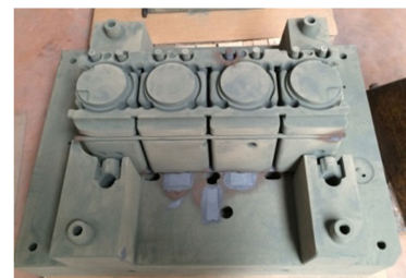
Partie de moule sable imprimée
